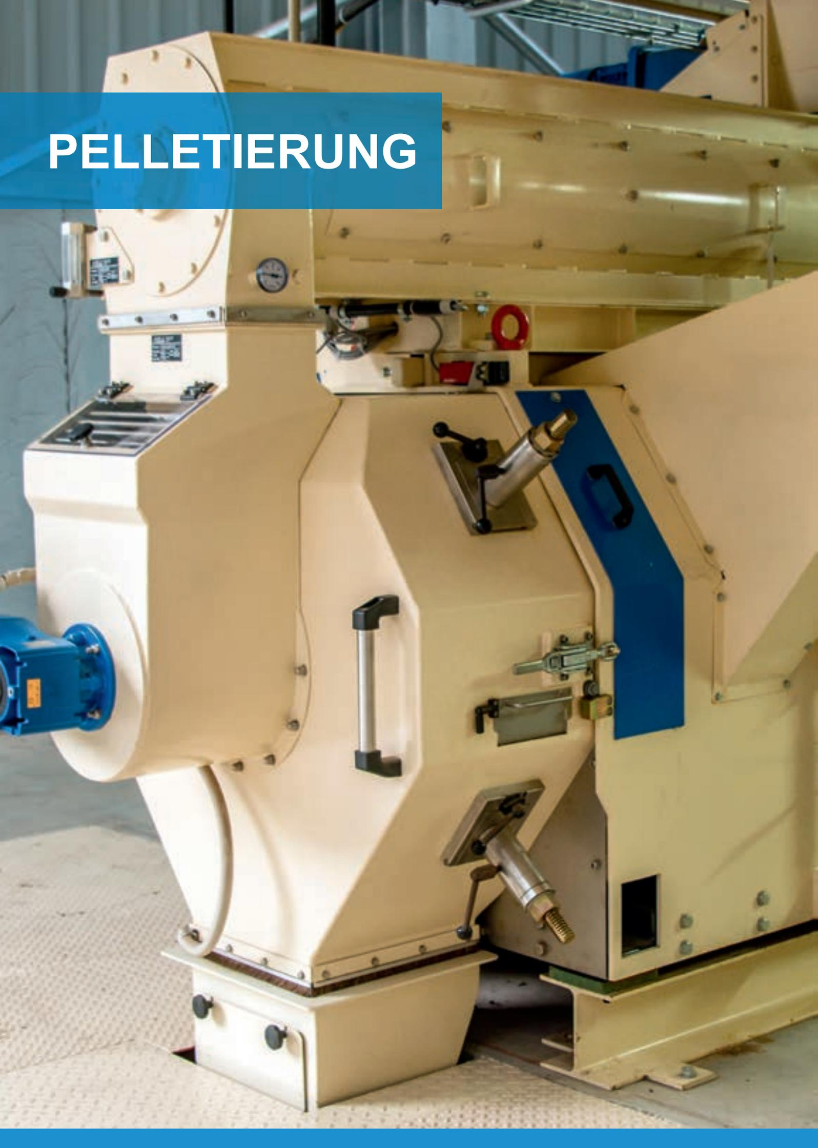
Wir planen und liefern Ihnen Gesamtanlagen zur Verarbeitung der Ausgangsprodukte über das Trocknen, Schreddern, Konditionieren/Pelletieren, Kühlen, Sieben bis hin zur Beladung der LKW's. Auf Anfrage können unsere Kunden auch die entsprechenden Einzelkomponenten zum Pelletierprozess erhalten, die sich sinnvoll in jede Produktlinie einfügen lassen. In unseren Angeboten sind Beratung, Entwicklung, sowie Einbau und Wartung ein fester Bestandteil.
